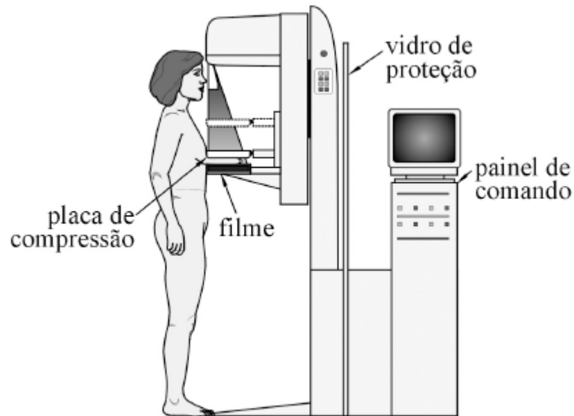
Figura 3.6 – Aparelho de mamografia com posicionamento do paciente e incidência crânio-caudal do feixe de raios X
